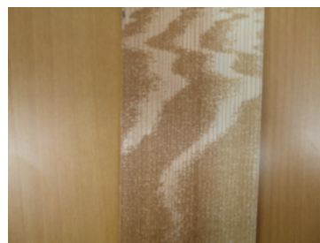
図6 杉板のレーザー加飾状態(試料#2)
